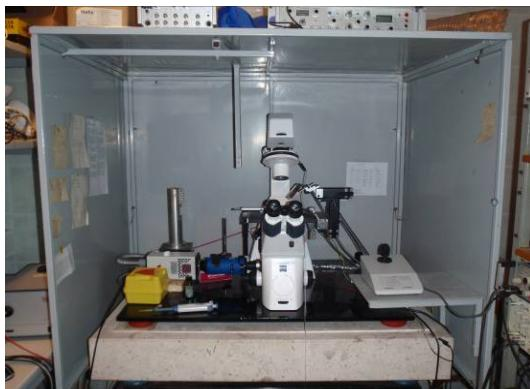
Slika 10: Mikroskop in mikromanipulator v ozemljeni faradayevi kletki in na antivibracijski mizi.
