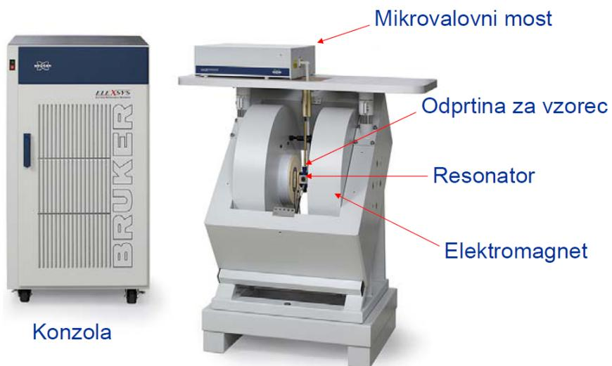
Slika 17: EPR spektrometer ELEXSYS E500 (Bruker, Nemčija) (Mravljak, 2010)
