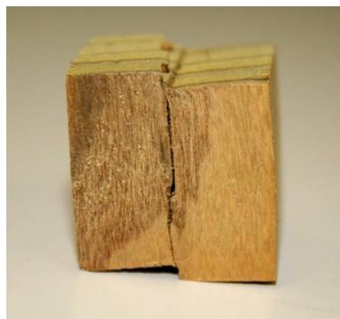
Slika 36: Porušeni vzorec lesa pri strižnem testu.
