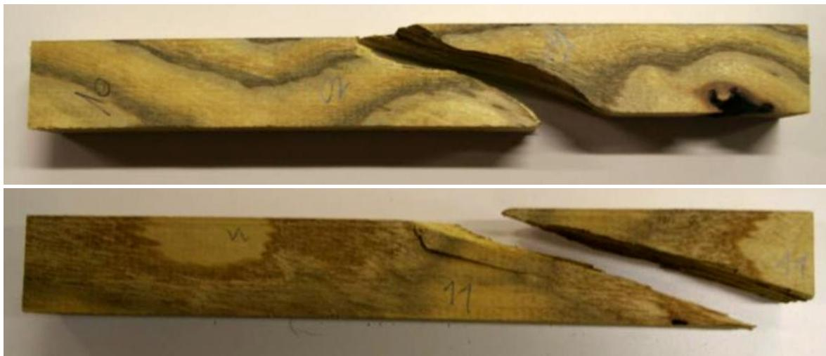
Slika 34: Porušeni vzorci po upogibnem testu.
