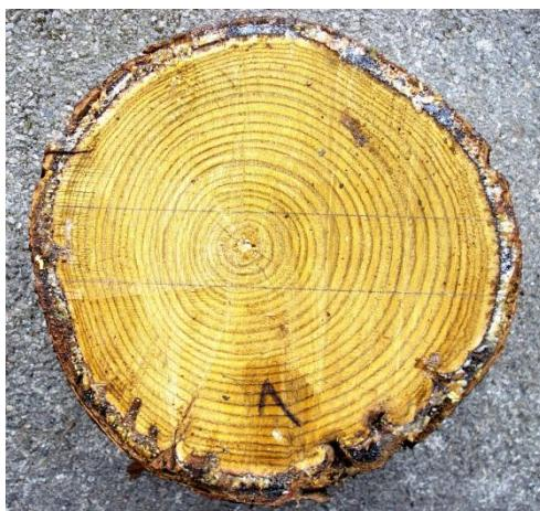
Slika 6: Kolut z označenim odvzemom vzorca za določanje radialne porazdelitve gostote in vlažnosti.
