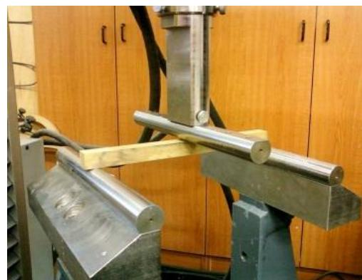
Slika 12: Preizkus upogibne trdnosti na stroju ZWICK Z100.
