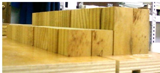
Slika 11: Vzorci za preizkušanje strižne (levo) in tlačne trdnosti.
