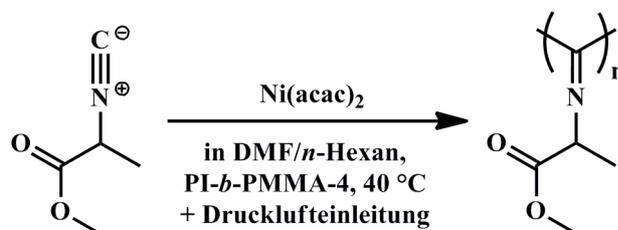
**Abb. 4-35:** Ni-katalysierte Polymerisation von **CNR-2** mit  $\text{Ni}(\text{acac})_2$  in n.-w. Emulsion.
