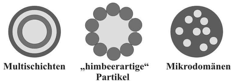
**Abb. 5-2:** Mögliche kinetisch kontrollierte Anordnung in Kern-Schale-Partikeln.
