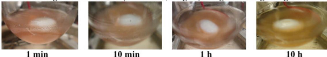
**Katalysator in reinem DMF (destilliert): kaum Vergiftung erkennbar**
