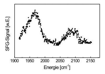
Abbildung 4.11: Das SFG-Spektrum nach der Korrektur der Gasphasenabsorption. Der nichtresonante Hintergrund ist noch vorhanden, aber konstant.
