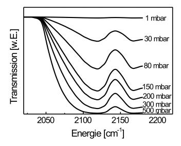
Abbildung 4.8: Aus der Anpassung an die gemessenen Absorptionskurven errechnete Gasphasenabsorption des CO bei verschiedenen Drücken.
