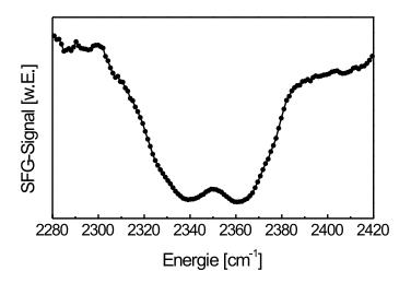
Abbildung 4.3: Die Gasphasenabsorption vom in der Luft enthaltenen  $CO_2$  gemessen mit Hilfe eines SFG-Spektrums vom GaAs-Kristall.
