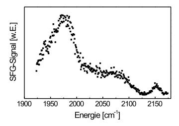
Abbildung 4.10: SFG-Rohspektrum nach der Umskalierung auf eine Energieskala
