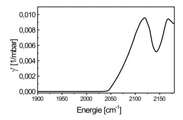
Abbildung 4.6: Qualitativer Verlauf des effektiven Extinktionkoeffizienten  $\gamma^{'}(E)$  über die Energie des IR-Lichts.
