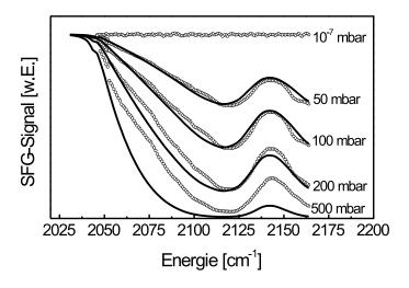
Abbildung 4.7: Gemessene (offene Kreise) und mit Hilfe der Literaturdaten angepasste (durchgezogene Linien) Gasphasenabsorption von CO bei verschiedenen Drücken.
