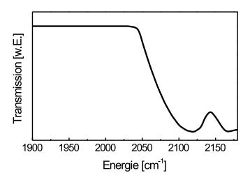
Abbildung 4.5: Qualitativer Verlauf der Gasphasenadsorption von CO über die Energie des IR-Lichts.
