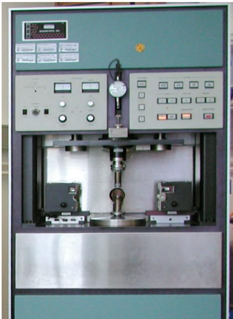
Das verwendete Rheometer RMS 800 (siehe Abb. 3.1) ist ein Scherrheometer, bei dem verschiedene Messsysteme angebracht werden können. Bei dem RMS 800 wird für die Messung an der unteren Platte eine Schwingung angelegt und der übertragene Impuls an der oberen Platte gemessen.
